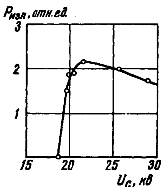
Рис.2 Зависимость интенсивности микроволнового излучения из разряда с длиной волны порядка 8 мм от напряжения зарядки конденсаторной батареи
